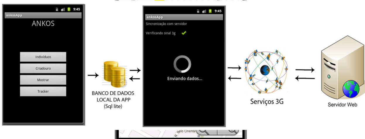
Figura 14: Fluxo de sincronia do ANKOS-Mobile com o Webservice Figura 12: Tela de Tracker
